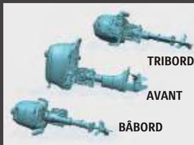
Le hors-bord est conçu pour pouvoir être déposé et placé indifféremment sur l'un de ses 3 côtés pour le remisage.
